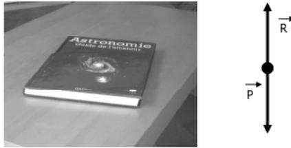
Figure 5.- Un livre posé sur une table et la modélisation des forces exercées sur le livre ( $P$  force exercée à distance par la Terre,  $R$  force de contact exercée par la table sur le livre).
